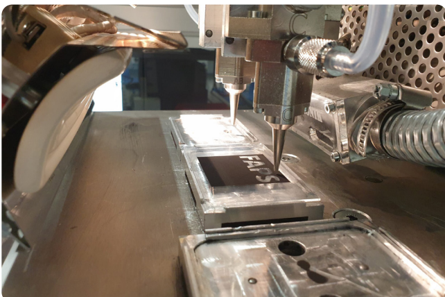
Aerosol-Jet-Anlage zum Verdrucken funktionaler Materialien. Foto: FAU / Sebastian Reitelshöfer
