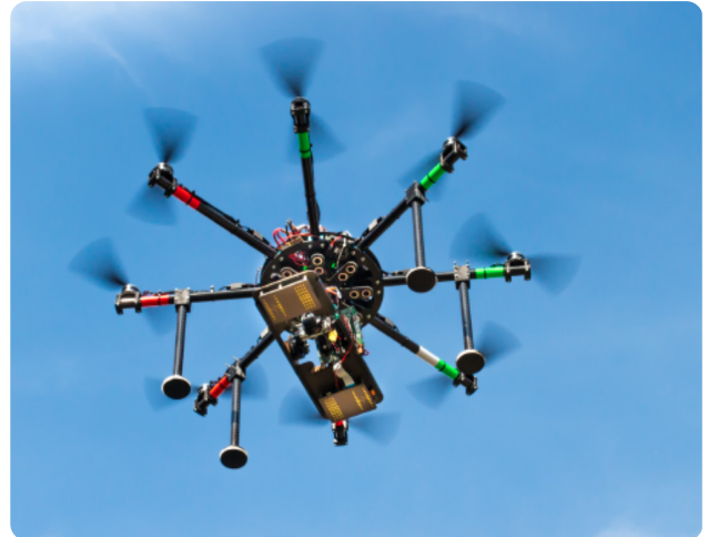
Mit Radar- und Funkortungstechnik ausgestattetes UAV (unmanned aerial vehicle) des LHFT (Foto: FAU/Lehrstuhl für Hochfrequenztechnik (LHFT))
