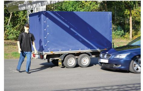
Testsituation für Ko-TAG: Die Puppe hinter dem Anhänger wird vom System erkannt, bevor der Fahrer sie sieht – das Auto bremst rechtzeitig.
