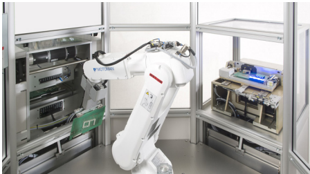
Automatisierter Test in einer Prüfzelle mit Roboterarm und flexiblen Prüfmodulen.
