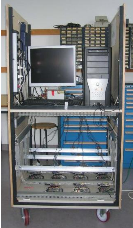
Remote-Zugriff über das Internet: Online Labor mit Server PC, FPGA-Boards und Webcams
