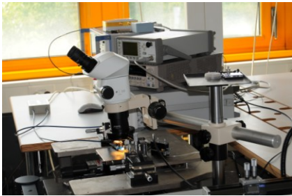
oben: Wafer Prober für Charakterisierung von Chips
